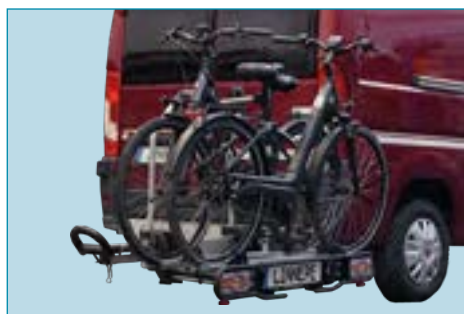
Schwenkbar - optimaler Zugang zu den Hecktüren
